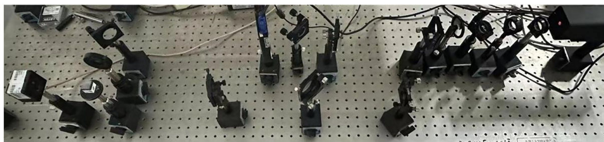
图 13 干涉法测量拓扑荷光路
